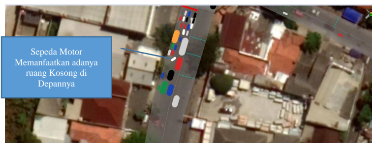
Gambar 3 Visualisasi Pergerakan Motor Hasil Perubahan Parameter “Collision Time” = 0.5 seconds, “Minimum Longitudinal Speed” = 0 m/s
