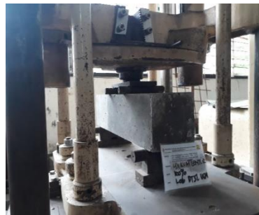
Gambar 38. Pengujian kuat lentur beton
