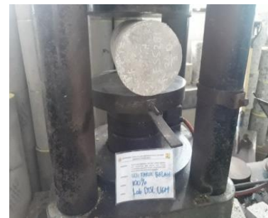
Gambar 39. Pengujian kuat tarik belah beton
