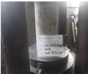
Gambar 37. Pengujian kuat tekan beton
